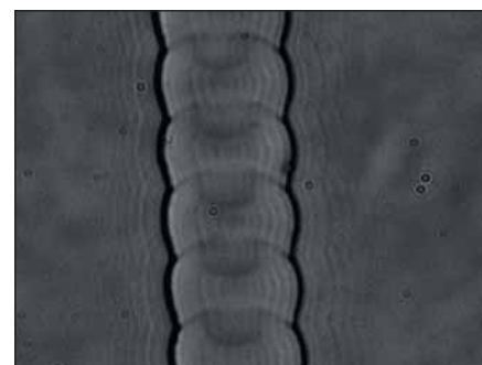
Рис. 6 Результат лазерной обработки TCO («процесс P1»), выполненной с помощью МЛП2
