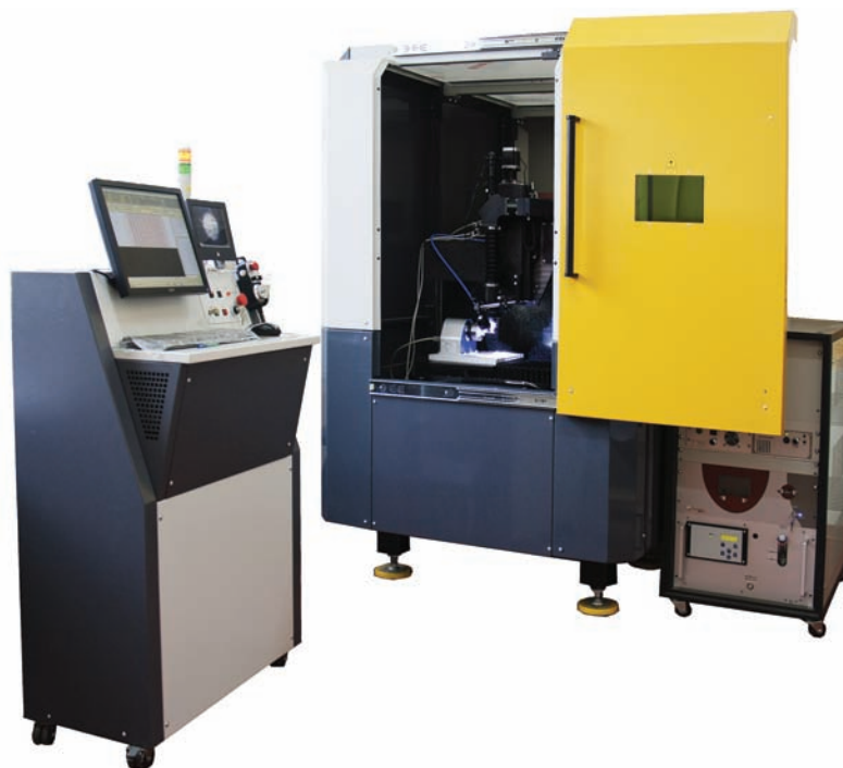
МЛП1 Фемтолаб для резки биоразлагаемых стентов
