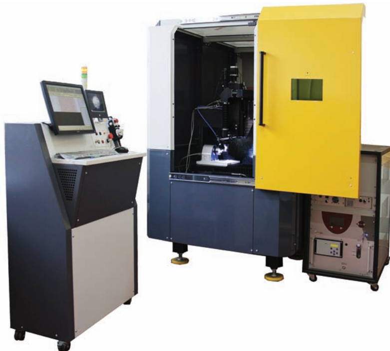
МЛП1 Фемтолаб для резки биоразлагаемых стентов
